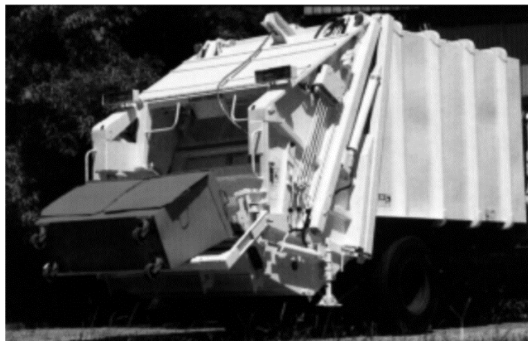
Figura 6. Contentor metálico padronizado para coleta de resíduos domiciliares por caminhão compactador e dispositivo basculante. Fonte: adaptado de Monteiro (2001).
