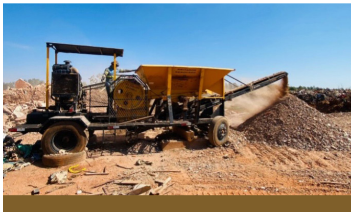
FIGURA 26: Beneficiamento dos RCC para produção de agregados. Fonte: TCE-MS, 2022.
